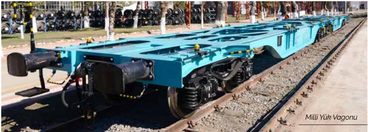
Yeni nesil milli yük vagonunda kullanılacak H tipi boji
