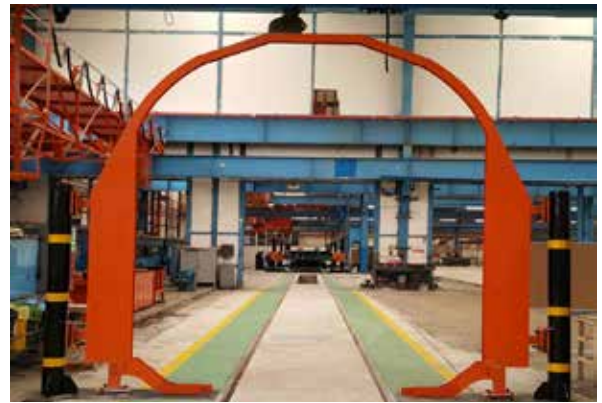
Gabari Ölçüm İstasyonu
